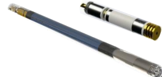
HT-2 Высокоэффективный Д-Д мини-генератор нейтронов для каротажа в необсаженной скважине ( Д-Д: 500 ч при 175^\circ\text{C} , 1 \sim 5 \times 10^7 н/с)
