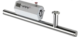
RT-3 Мини-генератор нейтронов с детектором \alpha -частиц для нейтронной безопасности (Д-Т : 1200 ч при 1 \times 10^7 н/с, \phi 76 мм )
