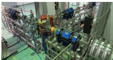
Дейтерий-тритиевый генератор нейтронов HINEG-I в Хэфэе ( 6.4 \times 10^{12} н/с)
