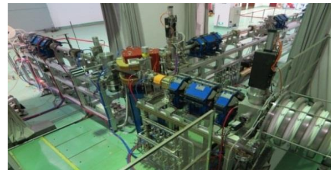
Дейтерий-тритиевый источник нейтронов (FNS) Мононейтронная энергия
