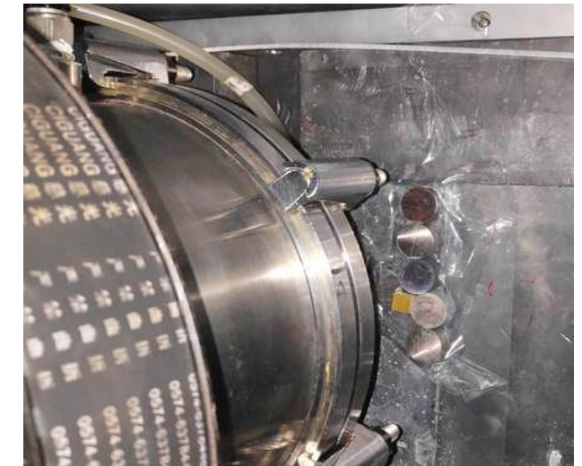
Эксперимент с активацией материалов для оборудования термояд. реакторов
