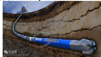
HT-3 мини-генератор нейтронов для каротажа каротажа во время бурения (Д-Т: 500 ч при 175^\circ\text{C} , 1 \times 10^8 н/с, антивибр. 20 гСКЗ, антиудар. 1000 г)
