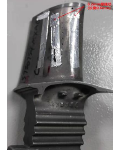
Обнаружение дефектов лопатки турбины двигателя
