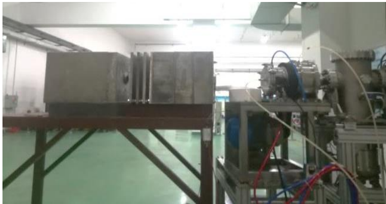
Определение нейтронных характеристик испытательного blankets модуля
