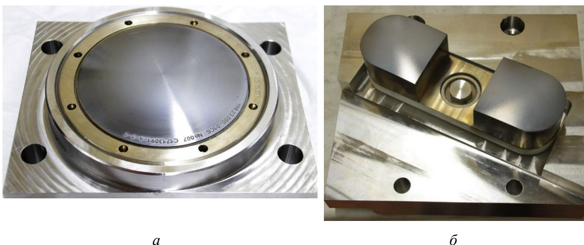
Рис. 14. Электроизолирующие накладки с покрытиями различного функционального назначения в сборе:
