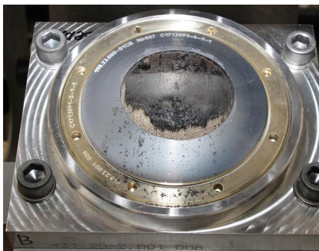
Рис. 16. Сборка цилиндрической накладки после 8000 циклов испытаний
