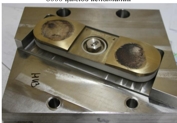
Рис. 16. Сборка цилиндрической накладки после 8000 циклов испытаний
