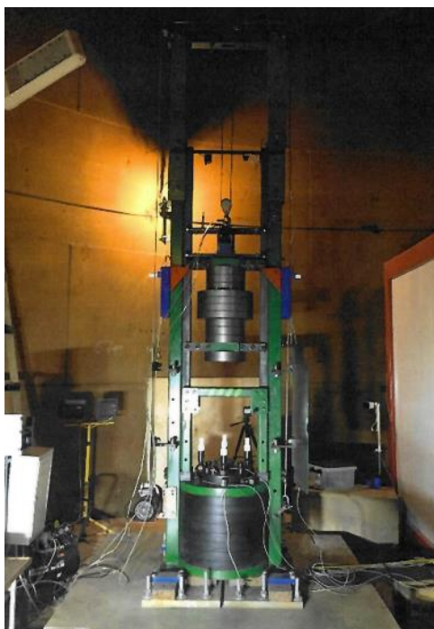
Рис. 11. Оснастка для ударных испытаний смонтированная на испытательной площадке ОИВТ РАН
