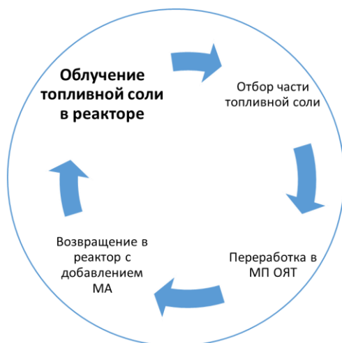
Рис. 5. Схема работы модуля переработки
