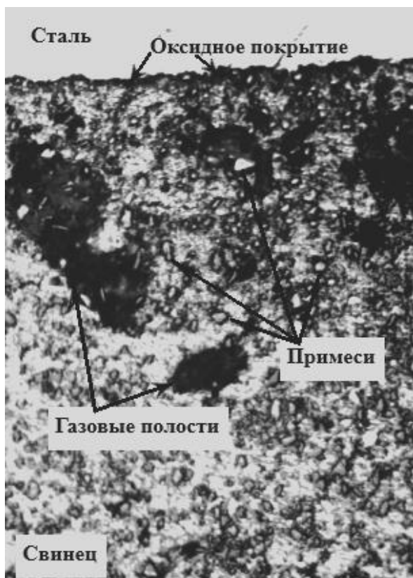
Рис. 3. Кольцевой зазор свинец-штулка при 200-кратном увеличении ( T=450^{\circ}\text{C} , t=50 ч, a=10\text{--}100 , n=700\text{об/мин} )
