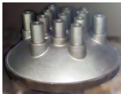
Рис. 5. Габаритно-подобный макет днища с патрубками
