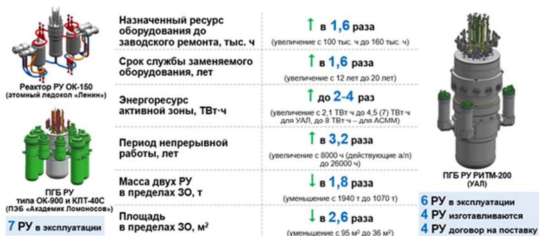
Рис. 5. Прогресс реакторных технологий: от блочной РУ КЛТ-40С к интегральной РУ РИТМ-200
