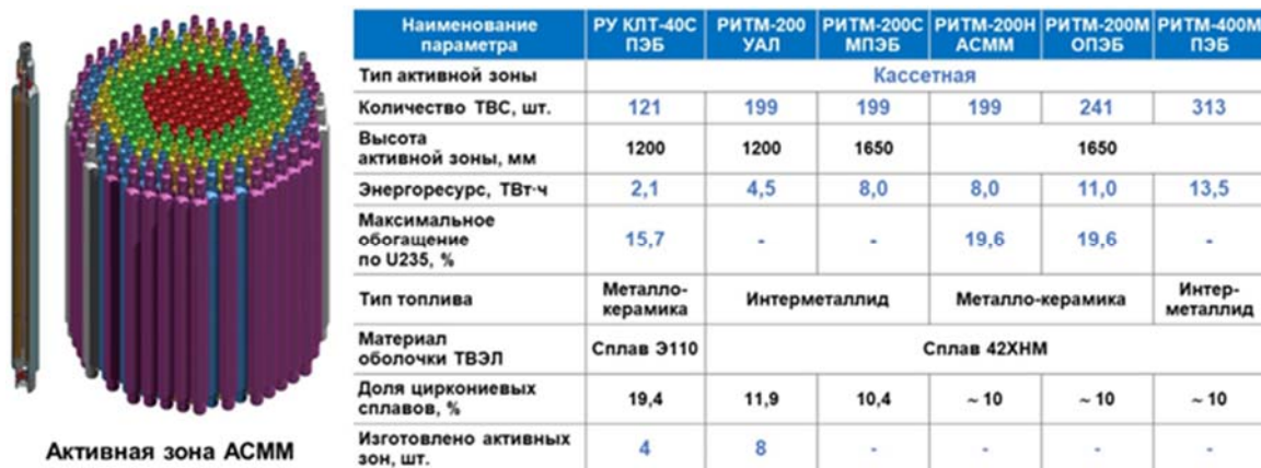
Рис. 7. Общий вид и поперечное сечение штатной ТВС активной зоны реактора РИТМ-200Н
