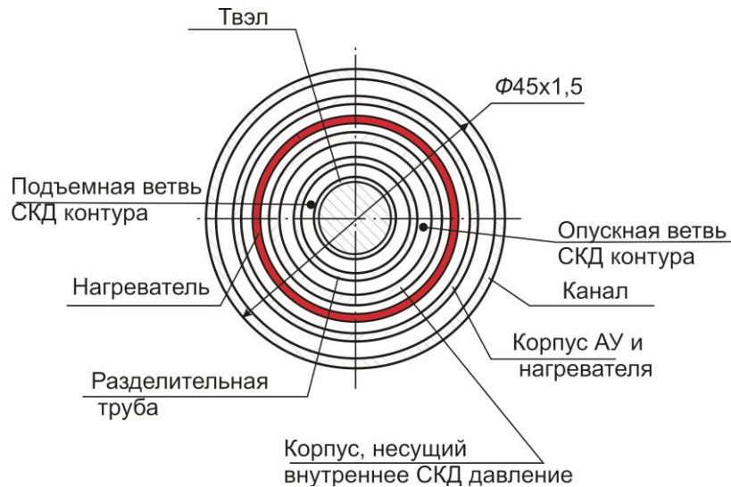
Рис. 2. Один из вариантов схемы сечения АУ-СКД с имитаторами твэлов для ячейки отражателя реактора б-4 (указанные размеры справочные)
