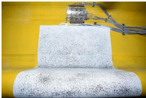
Место контроля деформаций
