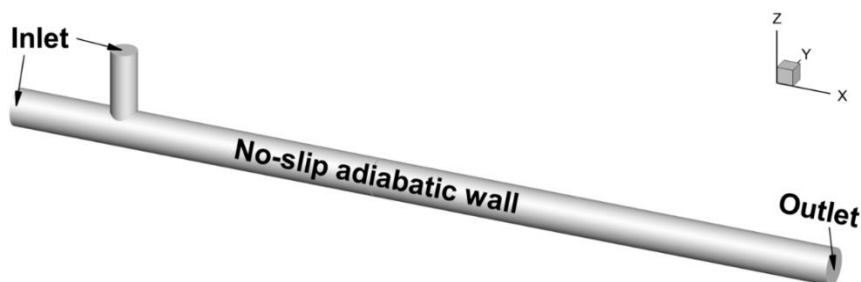
Рис. 3. Схема расчетной области и граничные условия для течения в Т-образном соединении труб
