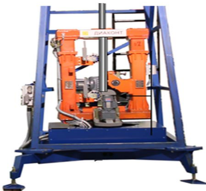
Рис. 1. Установка для резки графита производства АО «Диаконт», использовавшаяся на Ленинградской АЭС с 2013 по 2014 г.
