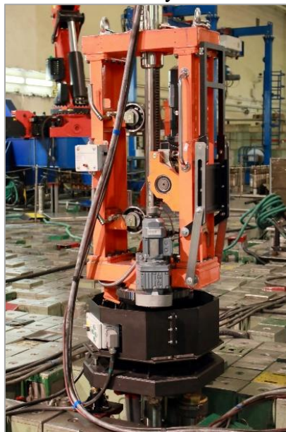
Рис. 2. Установка для резки графита производства АО «Диаконт», используемая на Ленинградской АЭС с 2016 г.
