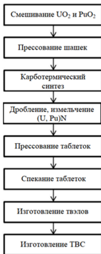
Рис. 2. Технологическая схема получения СНУП топлива на МФР ОДЭК
