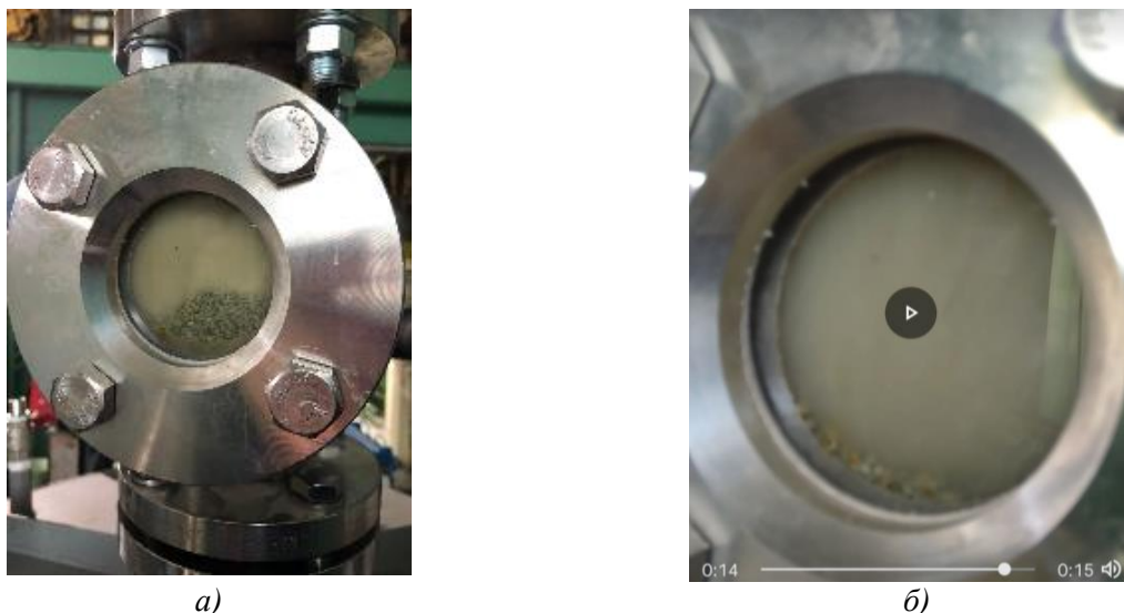
Рис. 3. Прозрачный фланец после заполнения фильтра-ловушки и остановки насоса (а) и при подаче пульпы в заполненную фильтр-ловушку (б)
