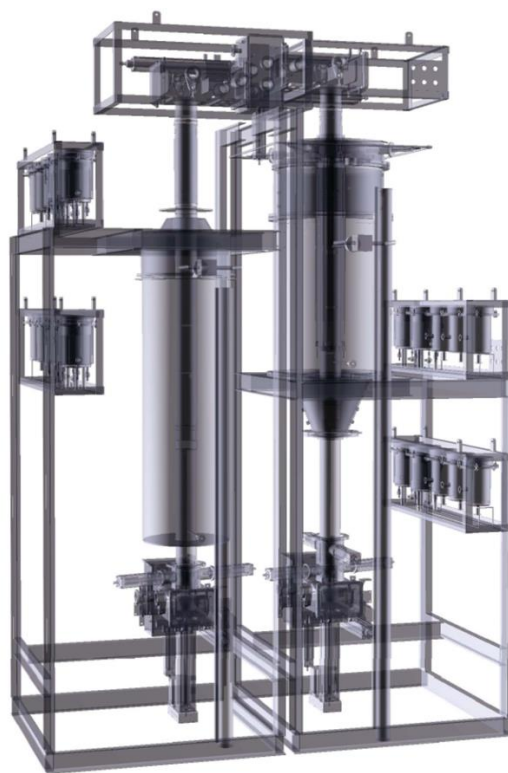
Рис. 3. 3D-модель установки спекания таблеток с установками газоочистки
