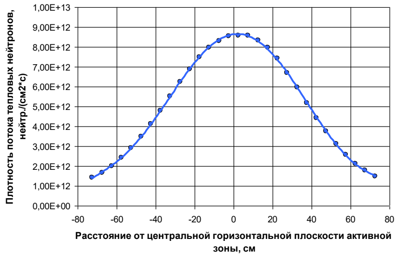
Рис. 3. Аксиальное распределение плотности потока тепловых нейтронов ( E < 0,625 эВ) по кремниевому слитку в диапазоне его перемещения в ВЭК-1,2
