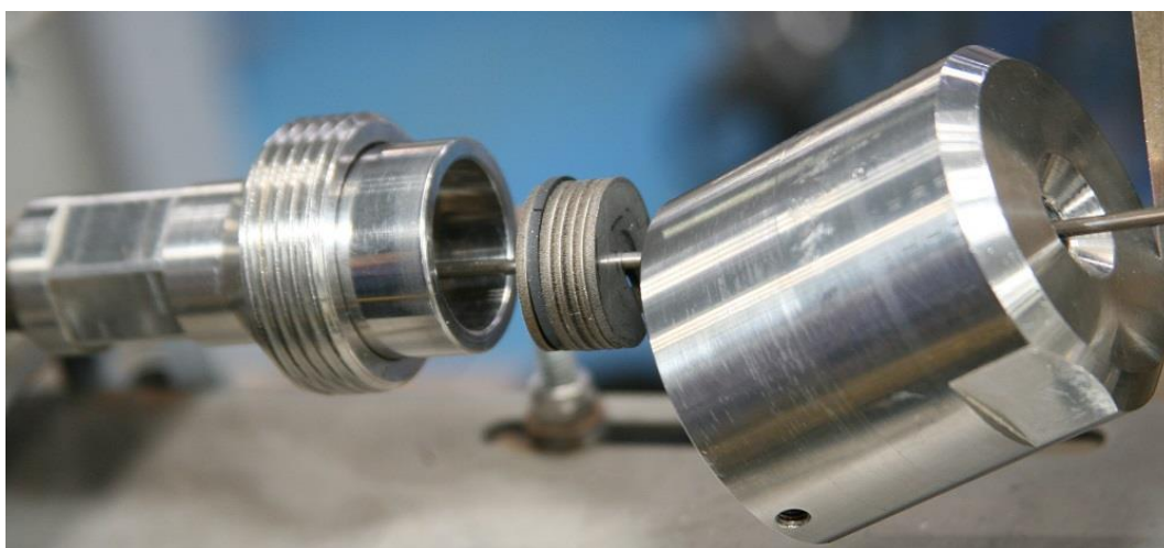
Рис. 4. Процесс сборки подвижного уплотнения капилляра
