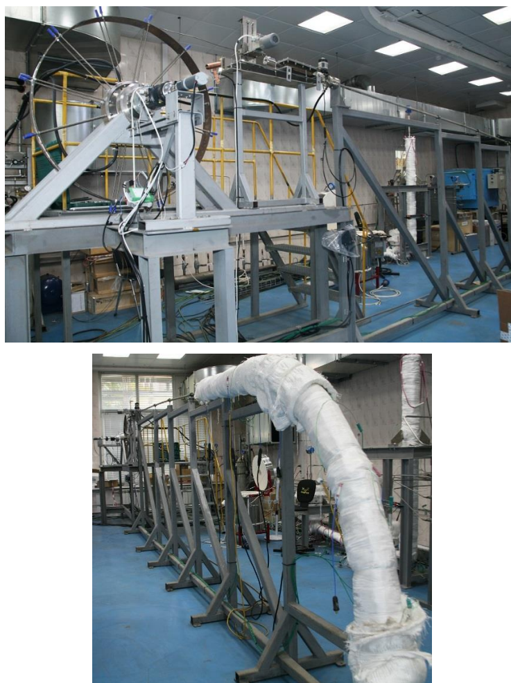
Рис.2. Общий вид макета пробоотборника и стенда: а – макет МТК; б – нагреваемая изогнутая часть имитатора канала пробоотборника стенда МТК
