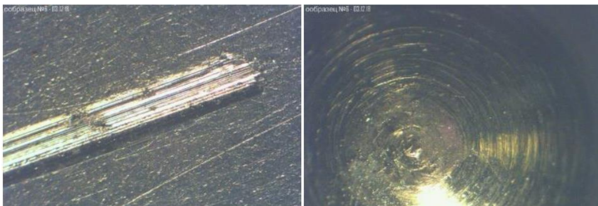
Рис. 11. След дорожки трения (слева) и состояние поверхности ответного стрежня (справа) после трибологических испытаний АФП/АСП
