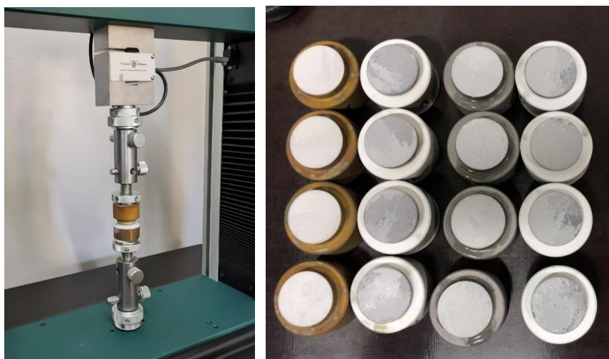
Рис. 3. Измерение удельного объемного электрического сопротивления ЭИП
