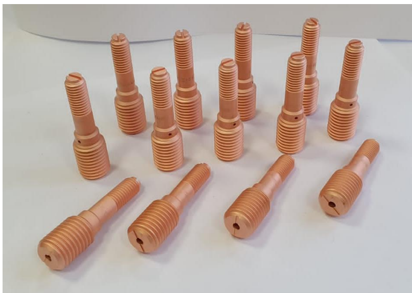
Рис. 15. Изделия с нанесенным антисхватывающим покрытием (АСП)
