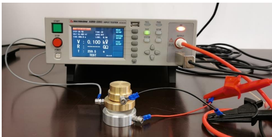
Рис. 3. Измерение удельного объемного электрического сопротивления ЭИП
