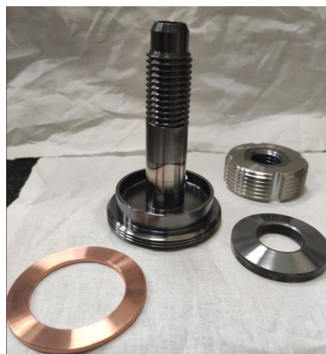
Рис. 12. Резьбовые пары до испытаний на закручивание-откручивание (слева болт без покрытия, справа все функциональные элементы с АФП/АСП)
