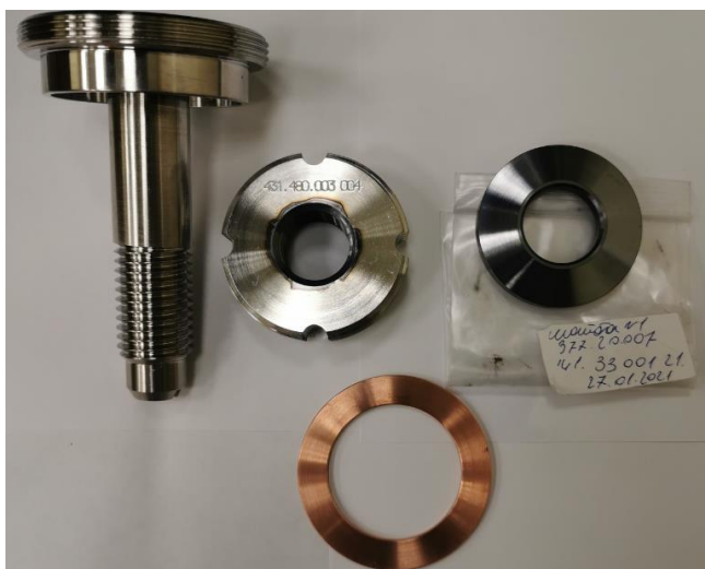
Рис. 12. Резьбовые пары до испытаний на закручивание-откручивание (слева болт без покрытия, справа все функциональные элементы с АФП/АСП)
