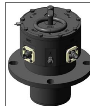
3D-модель головки подвески
