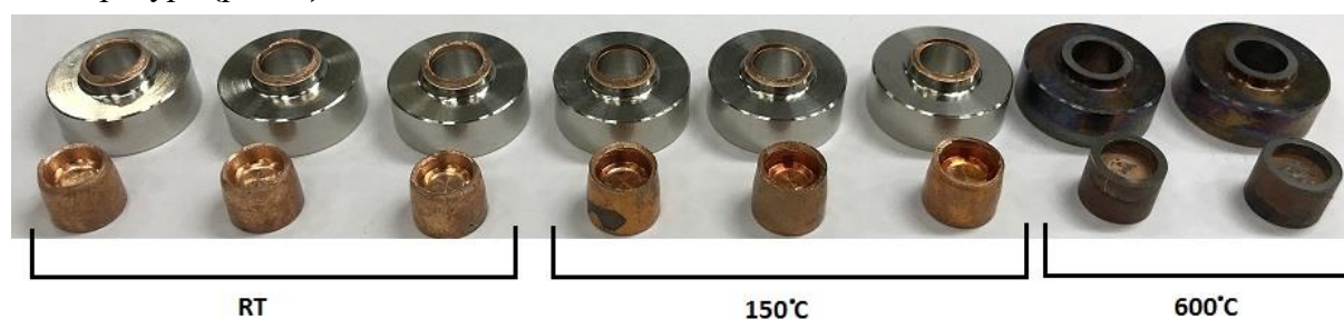
Рис. 6. Фотографии биметаллических образцов после испытаний на отрыв слоя
