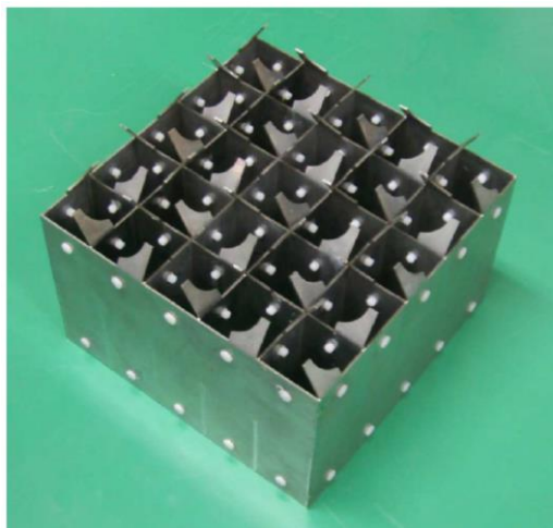
Рис. 2 Используемые в экспериментах MATiS-H завихрители типа “split” (слева) и “swirl” (справа) [1]
