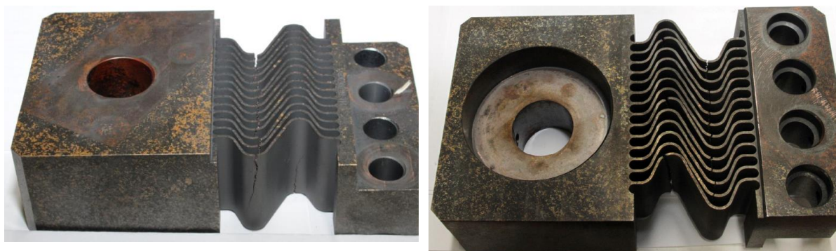
Рис. 13. ЭС 141.65.005 KB-1, изготовленный в АО НИКИЭТ из бронзы АО «Завод «Красный Выборжец» после 3-й стадии испытаний
