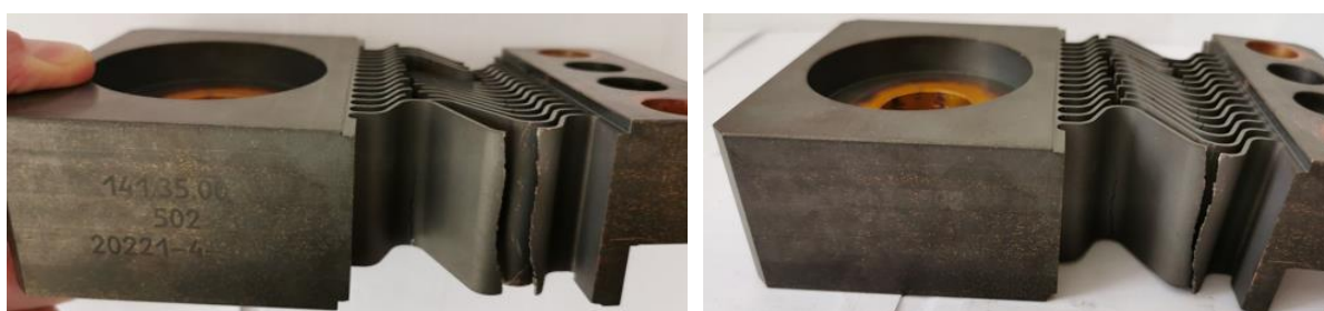
Рис. 11. ЭС 141.35.002 502 изготовленный в ФГУП «ПСЗ» после 3 стадии испытаний
