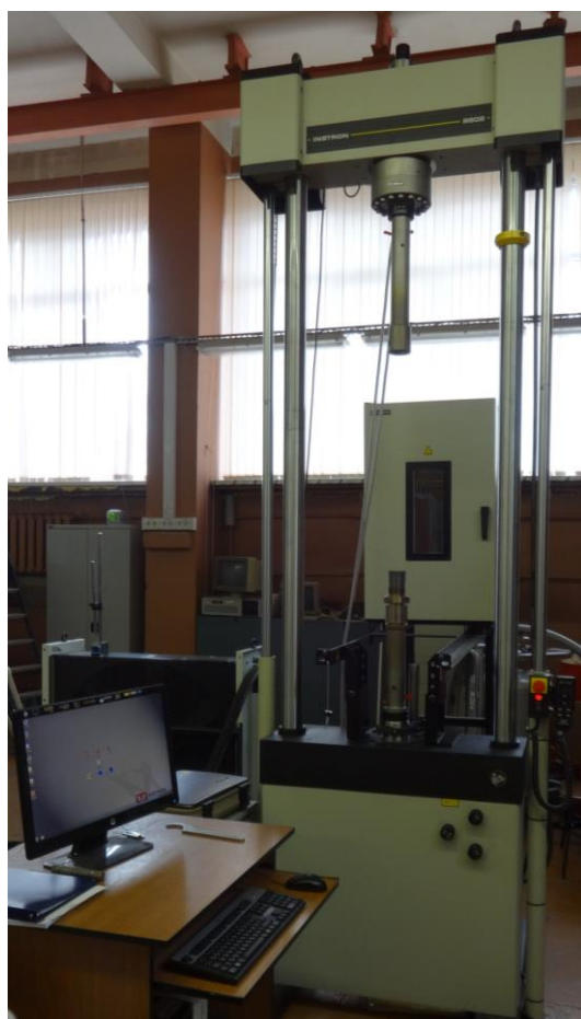
Рис. 3. Испытательная машина Instron 8802
