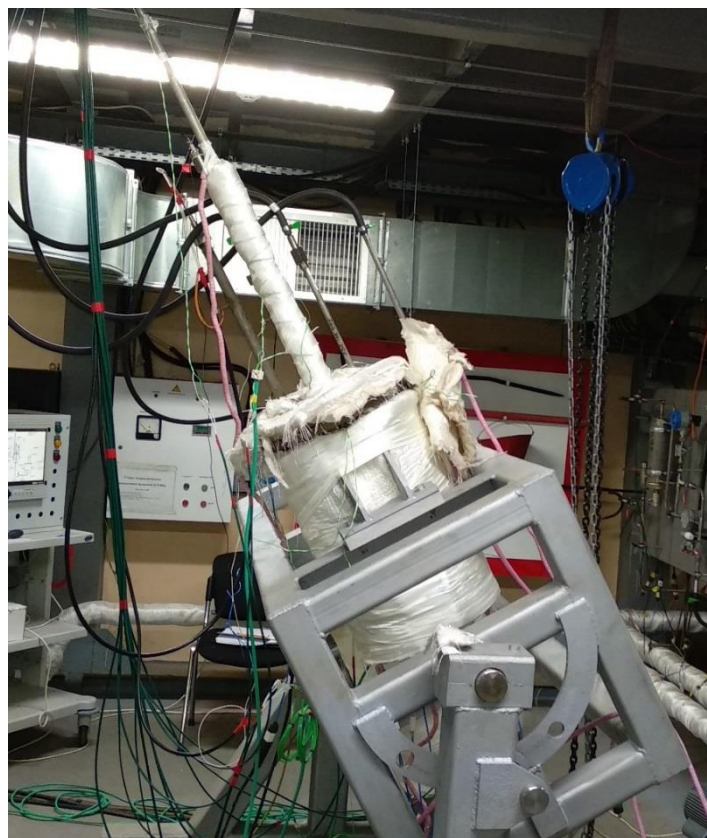
Рис. 12. Испытательный бак ЭУ под углом 30°
