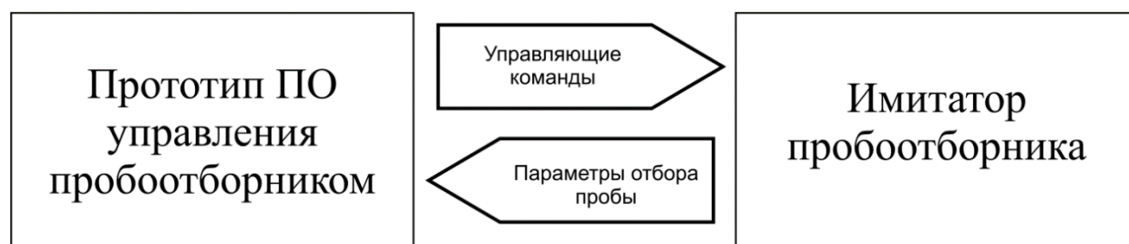
Рис. 18. Схема взаимодействия имитатора и прототипа ПО
