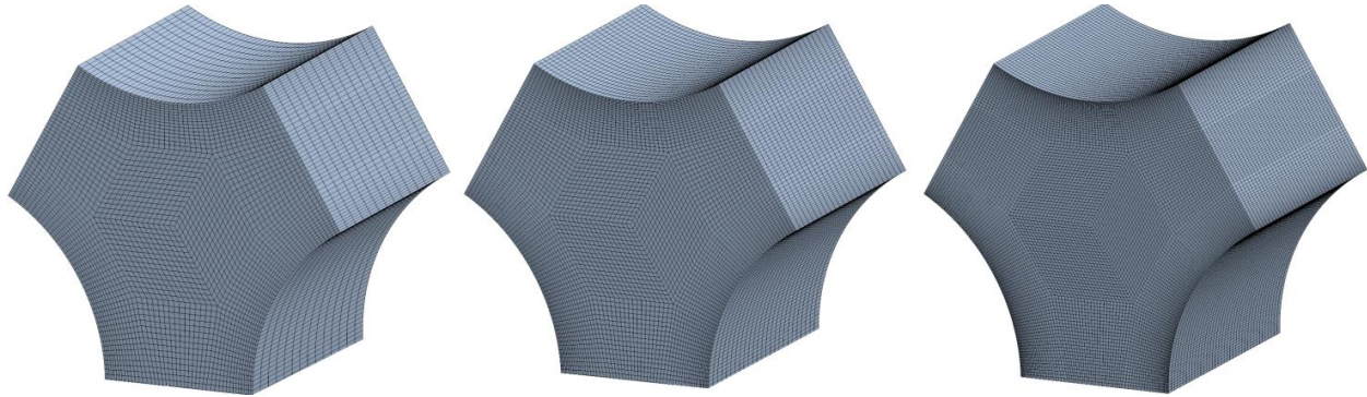
Рис. 2. Фрагменты расчетных сеток: Re=2500 (слева), Re=5000 (середина) и Re=10000 (справа)
