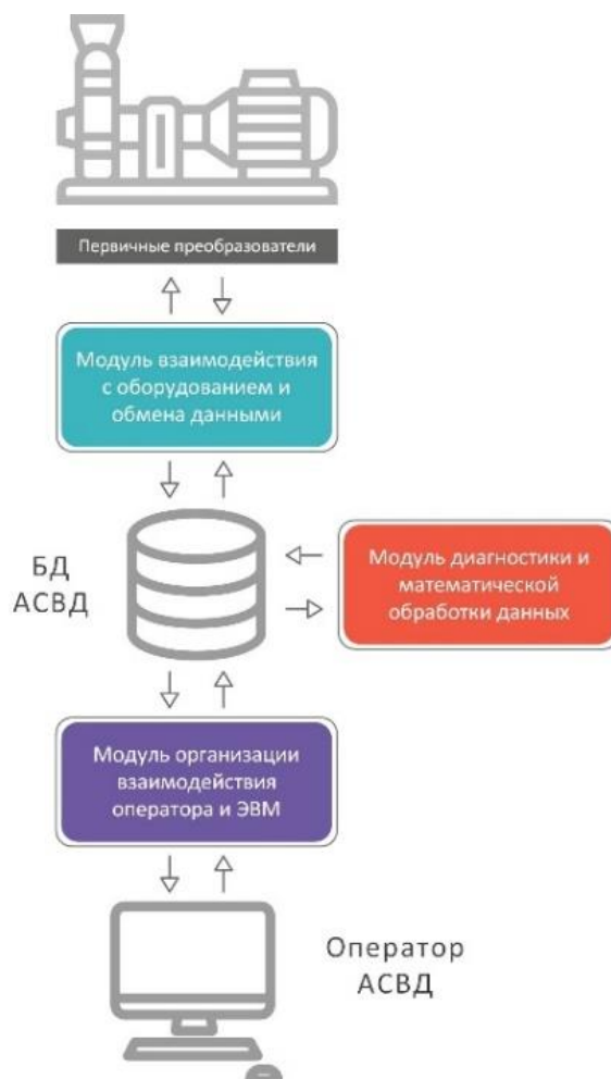
Рис. 1. Структурная схема программной части системы вибродиагностики
