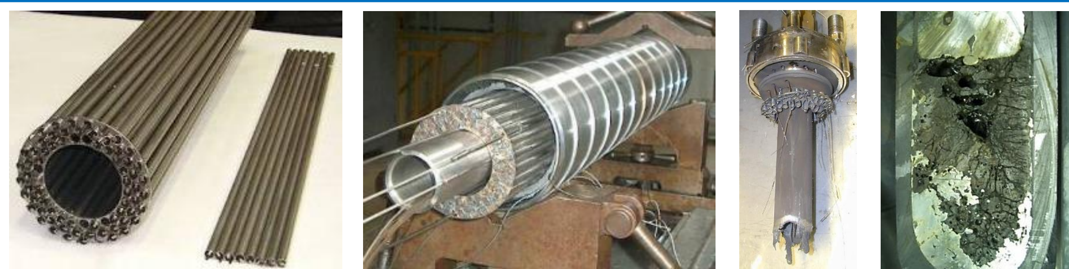
Компоненты топливной сборки до и после испытаний
