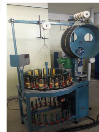
Изготовлена машина плетения волокнистых каркасов SiC и изготовлен волокнистый каркас
