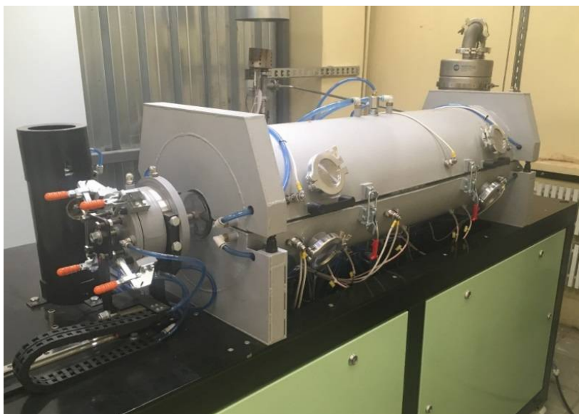
Установка осаждения из газовой фазы
