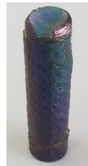
Образец трубы-оболочки с припаянным концевым элементом, покрытый слоем SiC из CVD
