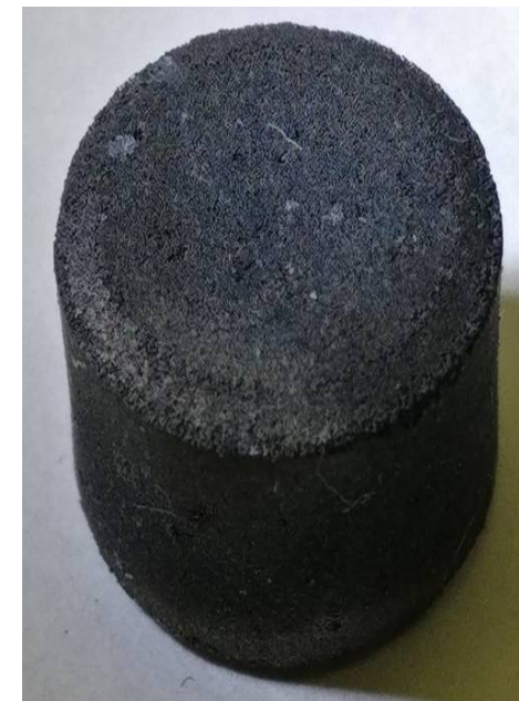
Внешний вид спеченной уран-молибденовой таблетки, изготовленной методом порошковой металлургии
