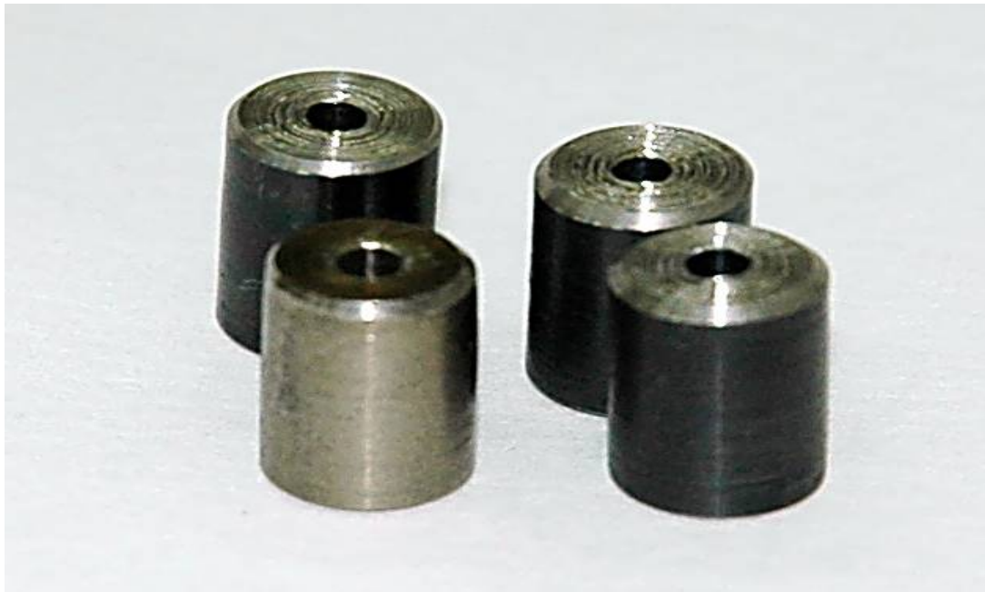
Внешний вид уран-молибденовой таблетки изготовленной методом литья
