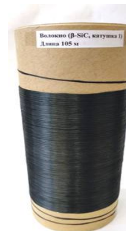
Получены образцы керамических волокон \beta -SiC
