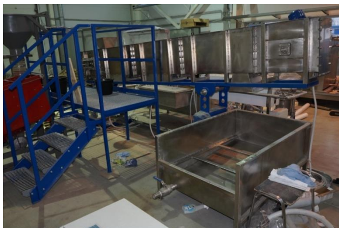
Рис. 6. Опытно-промышленная установка ультразвуковой дезактивации
