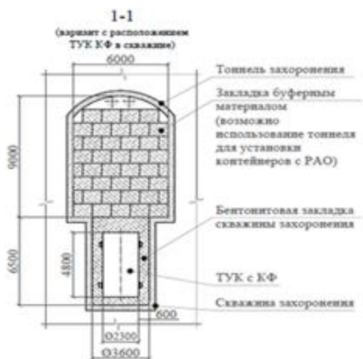
Рис 1. Оценка теплового состояния ПЗРО при компоновке УКХ ПВ с КФ ВАО в соответствии с концепцией KBS-3V
