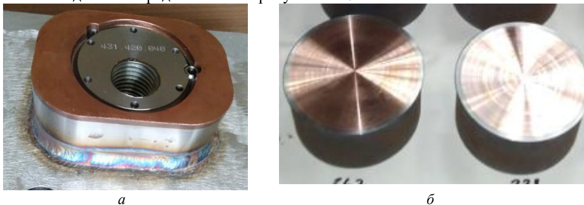
Рис. 12 – Общий вид пьедестала ЭС: а – пьедестал ЭС; б – заготовки для ГИП
