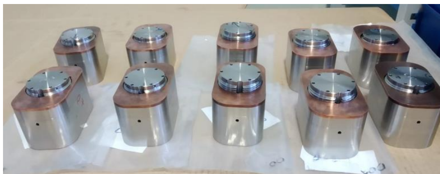
Рис. 23. Общий вид пьедесталов ЭС с резьбовыми втулками
