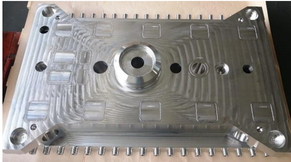
Полномасштабный прототип НКПС (после приварки крышек)
