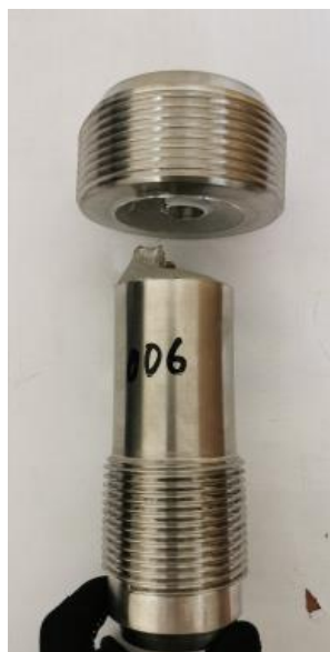
Рис. 20. Общий вид болтов после испытаний на предельное усилие (этап 2)
